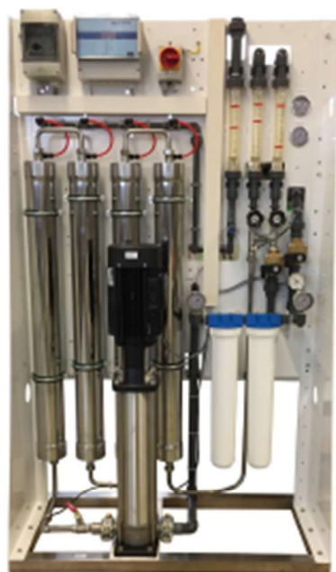
Dargestellt ist eine RO-1200 mit 4 Membranmodulen, sonst baugleich zu den Alternativen
