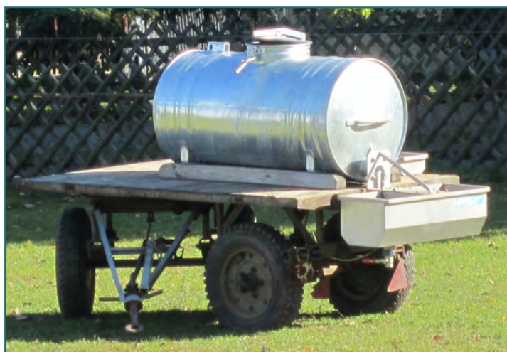
Sonderanfertigung: HAASE-Trogtränke Mod. Kippling an einem Wasserwagen
